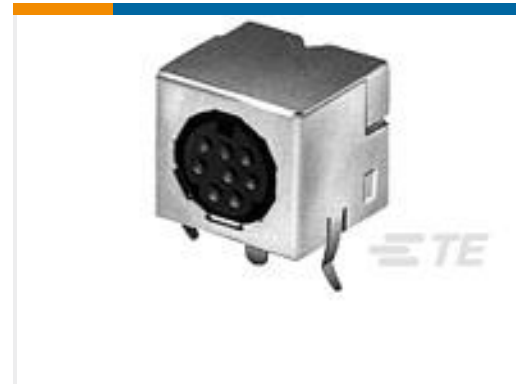
TE Part #5749181-1 Mini DIN, 4 pos, R/A, Shield
