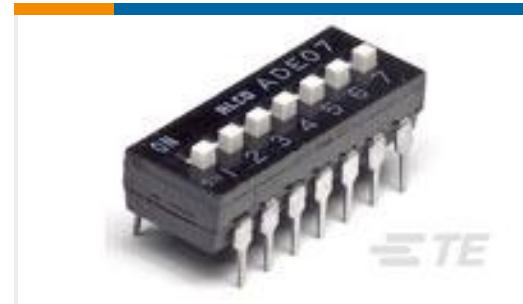
TE Part #1825057-4 ADE0504=DIP SWITCH,EXT,THRU/HL
