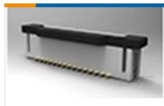
TE Part #3-1734248-0 1.0 FPC, ZIF V/T, SMT, 30P
