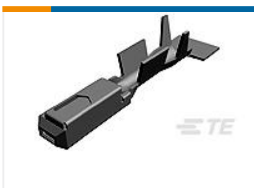
TE Part #5-1241608-1 MQS1,5 Sn rec CB unseal. 0,75-1,5
